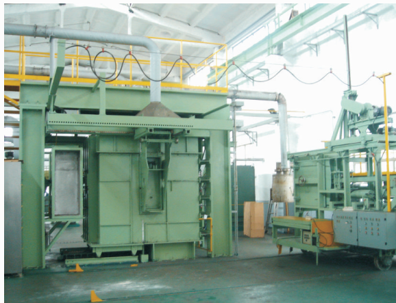
300kg电加热试验焦炉 300kg Electrical heating test coke
