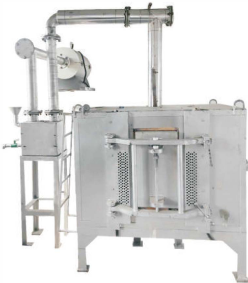
环保型试验焦炉
