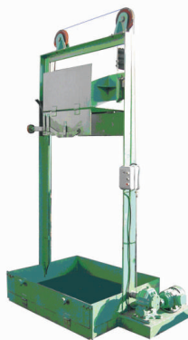
LX-2电动落下装置 LX-2 Coke dropping device
